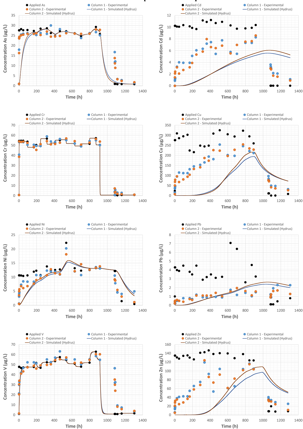
Figure 39 : Valeurs de la concentration en micropolluants métalliques mesurées (ronds) en entrée et à 5 cm des colonnes de Rainclean® et prédites (lignes) à 5 cm par modélisation directe par le modèle de transport avec dispersion et adsorption cinétique dans Hydrus-1D
