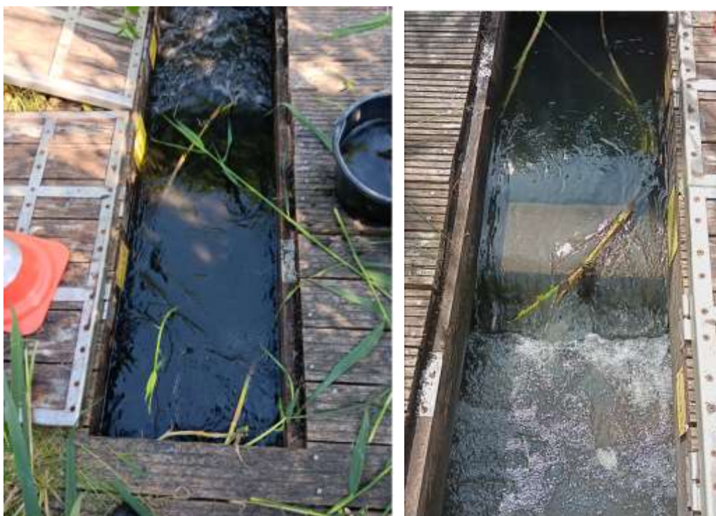
Figure 19: A gauche Eau très turbide arrivant de la station de pompage et alimentant le filtre F. Débordement vers le filtre R. Eau très claire débordant du filtre R vers le filtre S (13/06/2024).
