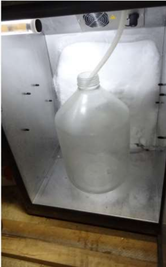
Figure 23: dysfonctionnement du groupe froid d'un des préleveurs de la station de pompage.
