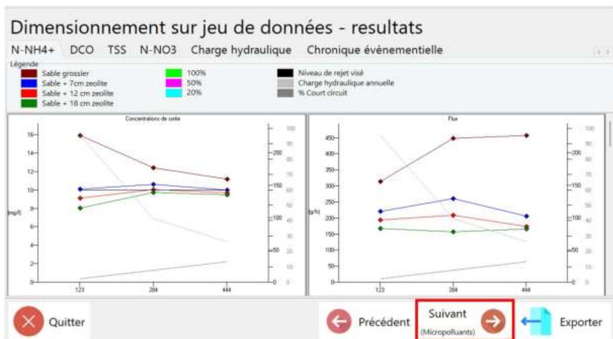
Figure 6 : Exemple de page de résultats représentant les concentrations et flux maximums pour le paramètre N-NH<sub>4</sub><sup>+</sup> fournie par le logiciel ORAGE à partir de laquelle le choix de simuler le devenir des micropolluants est possible
