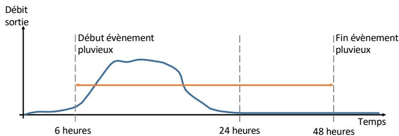
Figure 4 : Schématisation d'un évènement pluvieux pris en compte dans le logiciel ORAGE pour les calculs des indicateurs de performance du filtre de planté de roseaux
