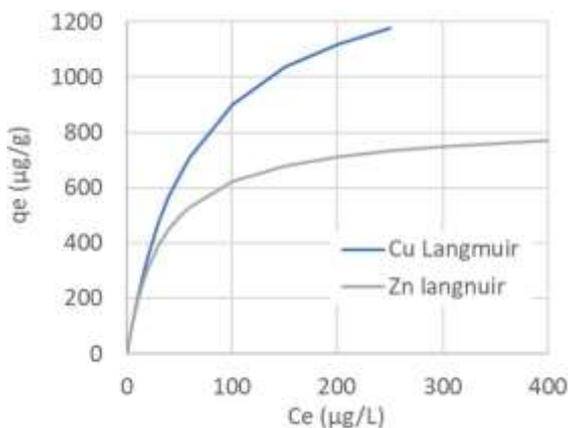
**Figure 2 : Isothermes d'adsorption du cuivre (Cu) et du zinc (Zn) sur le Rainclean®**
