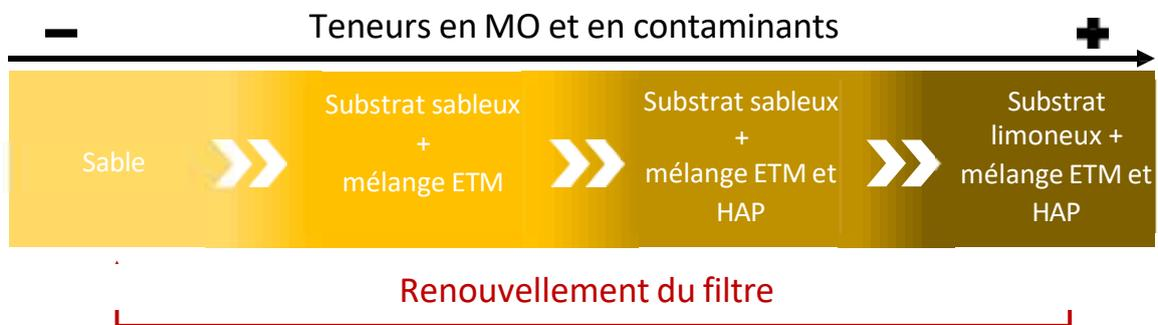
**Figure 24.** Etapes schématiques de l'évolution du milieu filtrant
