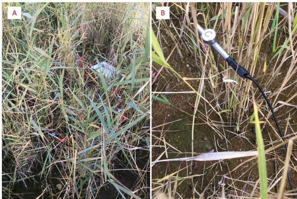
Figure 3. A) Vue de l'installation de la machine pour l'extraction des vers de terre dans la zone FR. B) Détail de l'électrode négatif placé au milieu de la surface de prélèvement.
