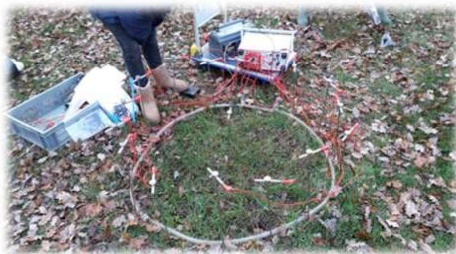
Photo 5 : Méthode électrique de prélèvement des vers de terre (échantillonnage de Décembre 2018) © J. Faburé
