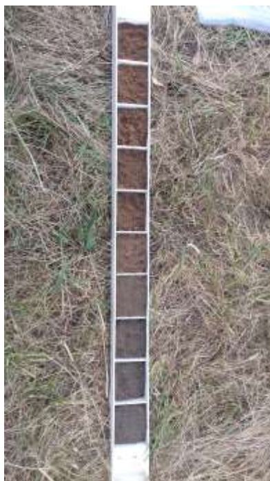
Photo 3 : Gouttière remplie des prélèvements à différentes profondeurs d'un profil de sol © I. Lamy
