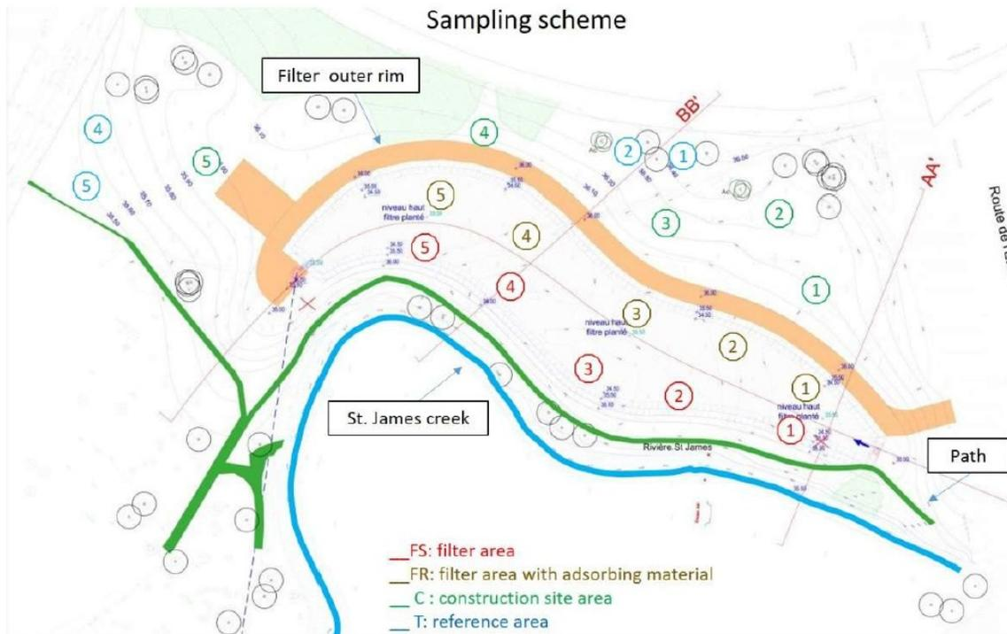
Une différence notable dans les analyses chimiques et biologiques a été observée entre la zone du filtre et les zones T et C. Il est donc essentiel de mettre en place un suivi intra-zone dans le temps afin d'évaluer précisément l'impact du filtre et d'assurer son suivi.
